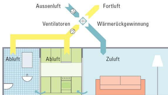
Bei einer Innensanierung oder einem Hausneubau werden immer mehr Komfortlüftungen eingebaut. Mit diesen wird die Luft automatisch erneuert, aber die Wärme bleibt im Haus.
